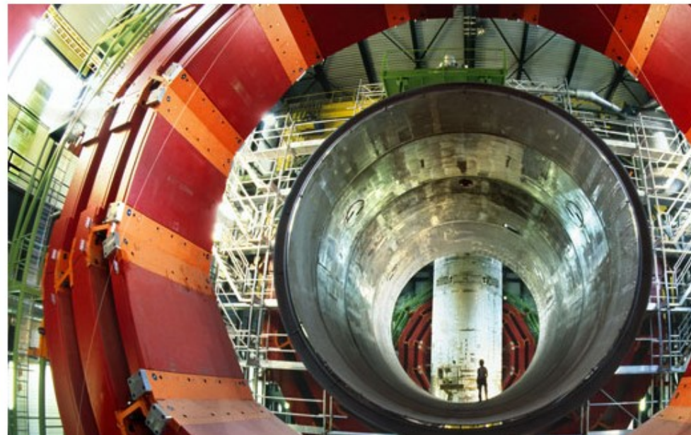
Електромагнет детектора миона великог хадронског колајдера (највећи електромагнет на свету, CERN)
