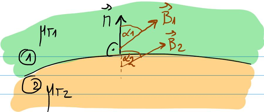
$$\text{Rot} \vec{H} = \vec{J} \quad \vec{n} \times (\vec{H}_1 - \vec{H}_2) = \vec{J}_s$$
